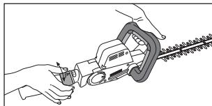
Con una mano impugnare la maniglia di guida e premere una delle tre barre d'avviamento.
